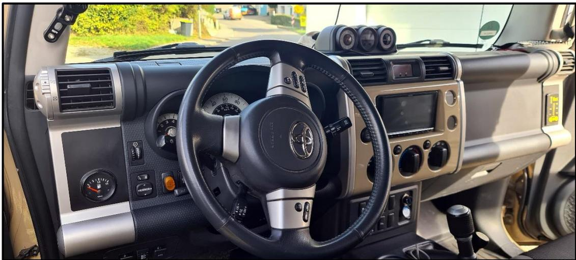
Zusatzarmaturen links Tankanzeige für den Zusatztank und rechts T-Max Batterieladesystem
