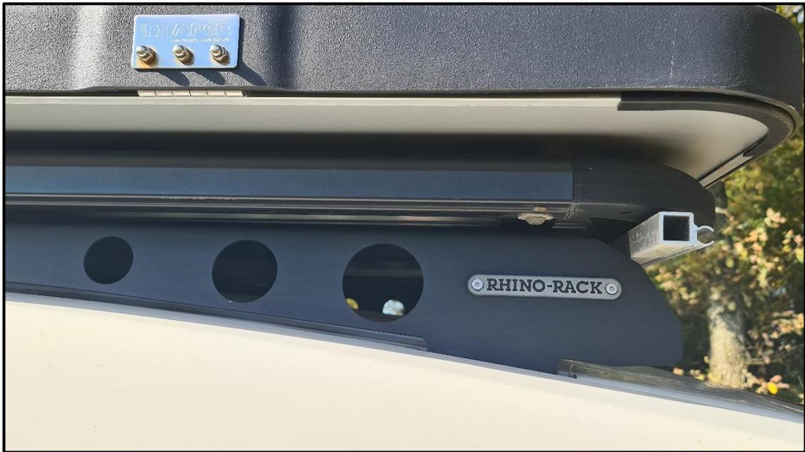
Verbauter Dachträger von Rhino Rack dient als Basis für das Dachzelt
