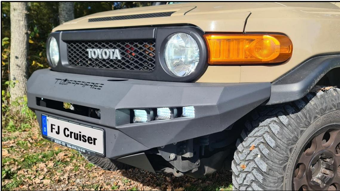
Stoßstange/Windenträger incl. 6x LED Arbeitsscheinwerfer, Hauptscheinwerfer LED Osram Night Breaker
